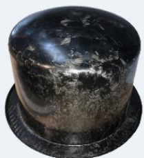
CFRTP深絞り圧力容器
