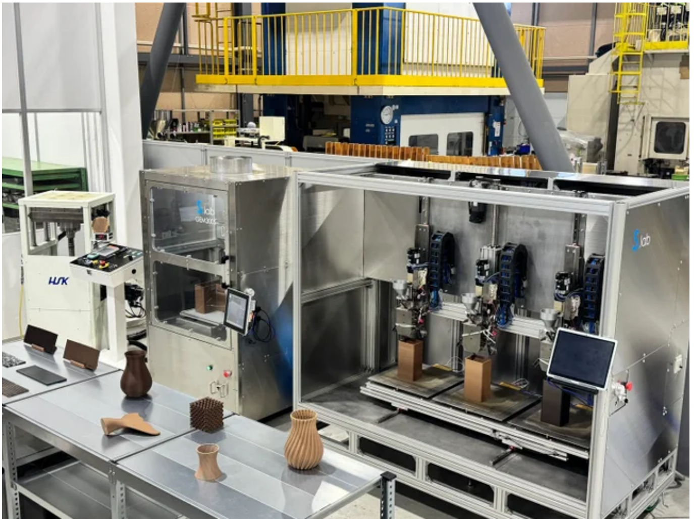
小型ホットプレス（熱プレス）成形試験機とペレット式3Dプリンターが並ぶ共創イノベーションラボ
